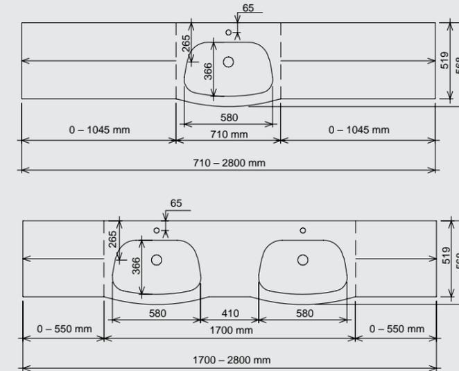
Sowohl Einzel- als auch Doppelwaschtische können zentimetergenau in den Nischen platziert werden. Die Unterschränke sind ebenfalls in Wunschbreite produzierbar. Durch das Weglassen eines Unterschranks entsteht ein Schminkplatz. Auch alle Flächen Spiegel lassen sich nahtlos aneinanderfügen und dadurch von Wand zu Wand planen.
